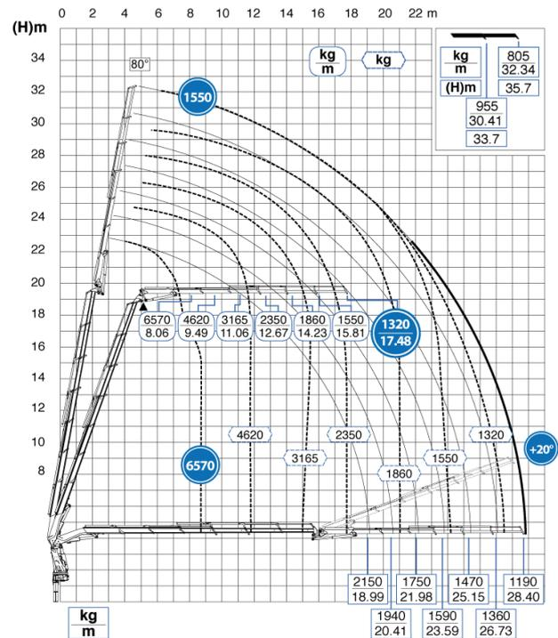
Das Lastdiagramm stellt das Maximum an Hebekraft unter optimalen Aufstellbedingungen des Ladekrans dar. Je nach örtlicher Gegebenheit kann die Hebekraft eingeschränkt sein.
